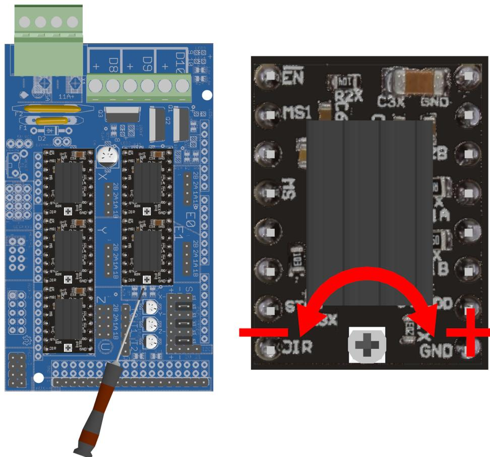
Le potentiomètre sur chaque driver comporte un méplat. Il faut les configurer en position médiane (c'est à dire avec le plat horizontal) et de tester les déplacements puis des impressions et voir si les moteurs se déplacent bien sans bloquer.
