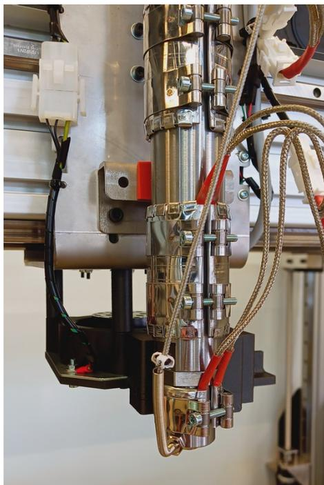
Plus encombrante que la 2K, l'extrudeuse 4K permet un débit deux fois plus important pour des applications spécifiques sur les imprimantes de grandes dimensions.
