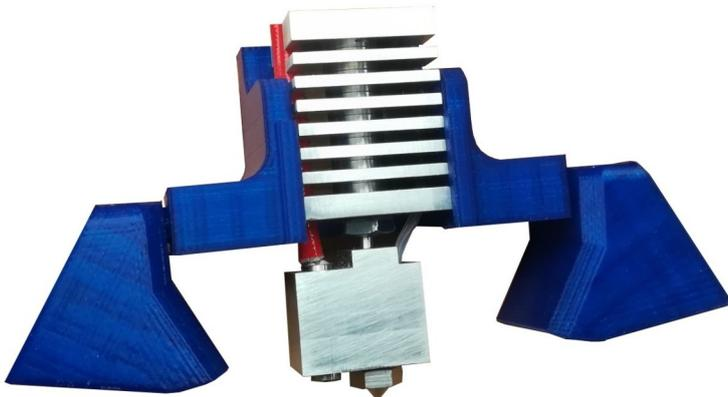
Un extrudeur de filaments biocompatible permet d'extruder des matériaux certifiés biocompatibles par un fabricant sans altérer cette caractéristique durant le processus de fusion et d'extrusion.
