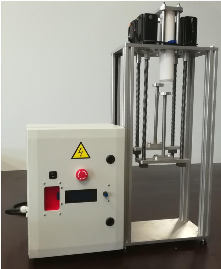
L'extrusion seringue est un système autonome à utiliser seul ou à insérer dans une machine existante. Ses seringues plastiques ou inox s'adaptent aux besoins de chacun pour extruder toutes sortes de matières molles, alimentaires ou non.
