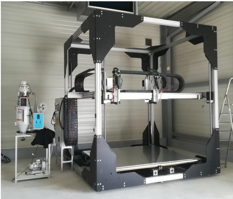
La Tobeca T8000 est une imprimante permettant d'imprimer directement des granulés de polymères tels que les PLA, ABS dans un grand volume de 8m<sup>3</sup> (2mx2mx2m).
